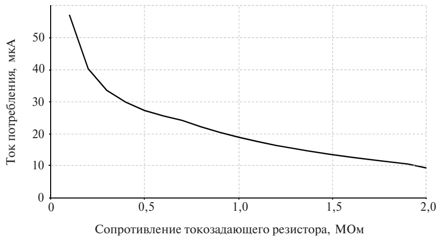
Зависимость тока потребления компаратора от сопротивления токозадающего резистора (БМК серии 5503)
