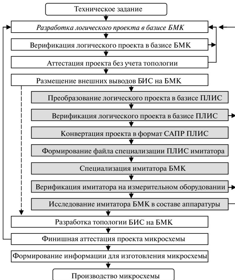
Рис. 5.8. Маршрут проектирования ПЗ БИС с применением имитаторов БМК
