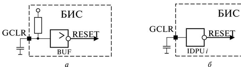
**Рис. 5.11.** Пример формирования сигнала начального сброса или установки: *а* – функциональная схема формирования сигнала начального сброса или установки; *б* – реализация схемы формирования сигнала начального сброса или установки с применением входных периферийных ячеек БМК
