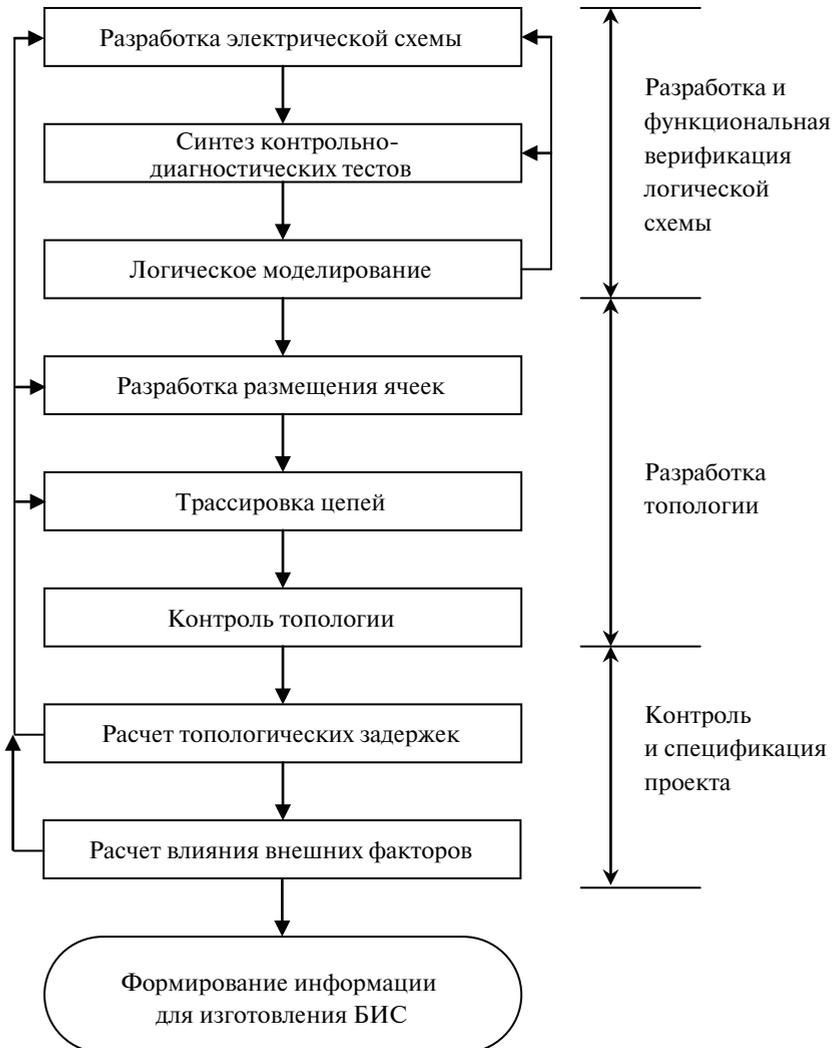
Рис. 5.2. Маршрут проектирования полужаказной БИС по технологии БМК
