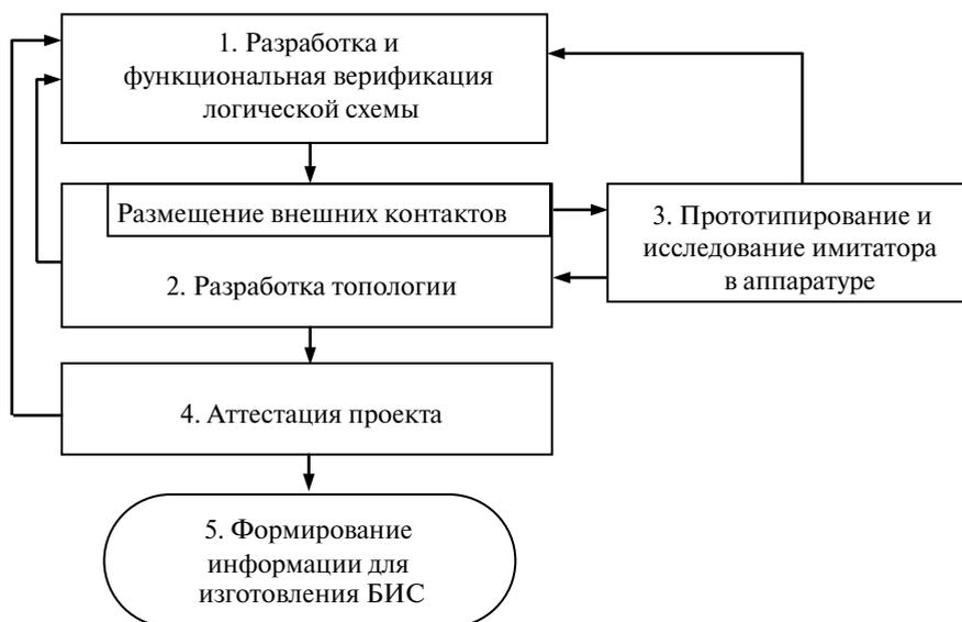
Рис. 5.33. Блок-схема маршрута проектирования полуказказных микросхем с применением имитатора
