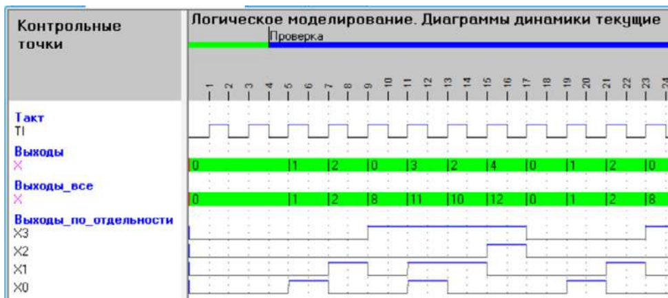
Рис. 8.7. Фрагмент результатов моделирования схемы пересчётного устройства с повторяющимися состояниями, построенного с использованием триггера-метки
