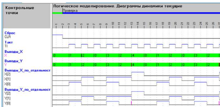
Рис. 8.11. Фрагмент результатов моделирования схемы пересчётного устройства с повторяющимися состояниями, построенного по структуре счётчик — комбинационная схема
