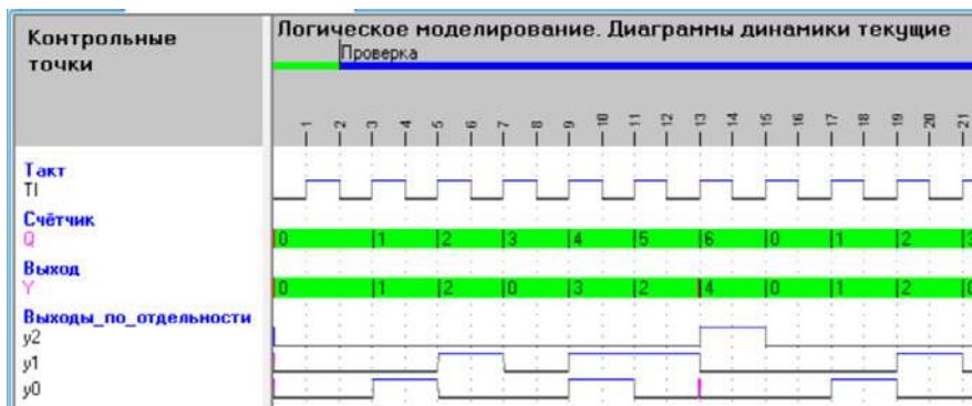
Рис. 8.9. Фрагмент результатов моделирования схемы пересчётного устройства с повторяющимися состояниями, построенного по структуре счётчик — комбинационная схема
