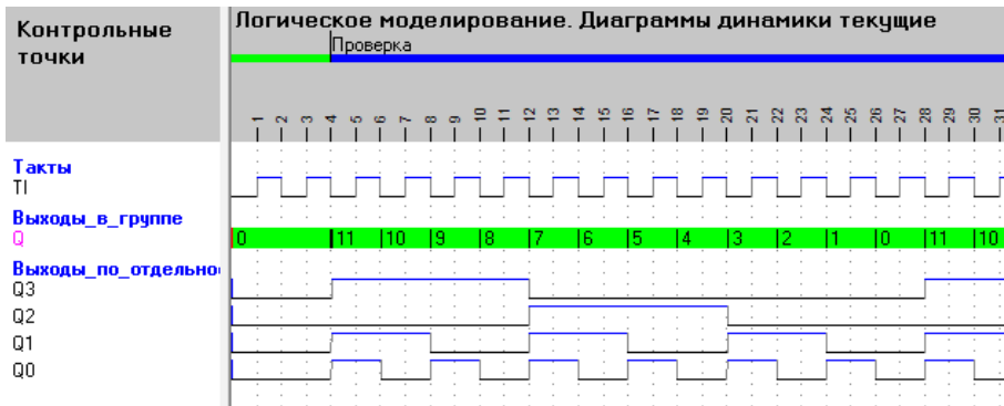
Рис. 7.14. Результат моделирования реализованного асинхронного счётчика в среде САПР «Ковчег»
