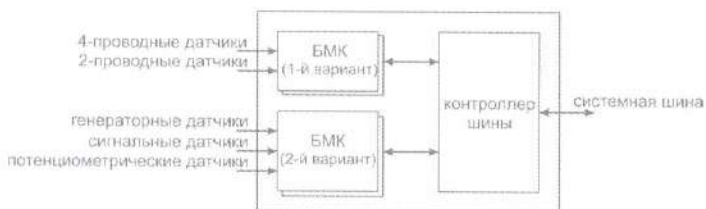
рисунок 4. Структурная схема модуля датчиков
