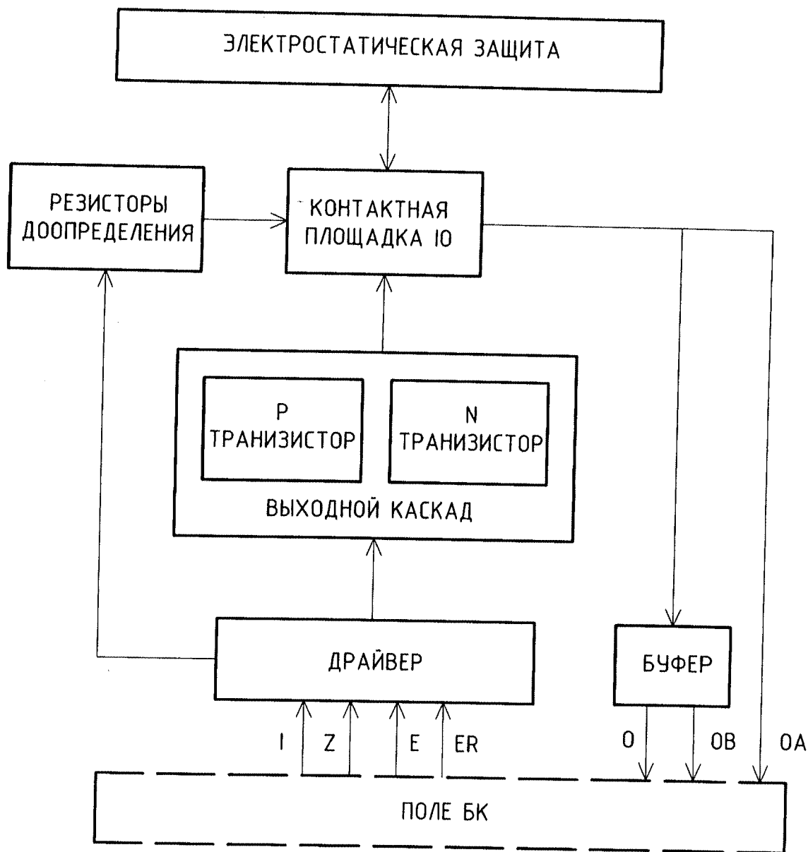
Рисунок 4 – Схема электрическая структурная периферийной ячейки
