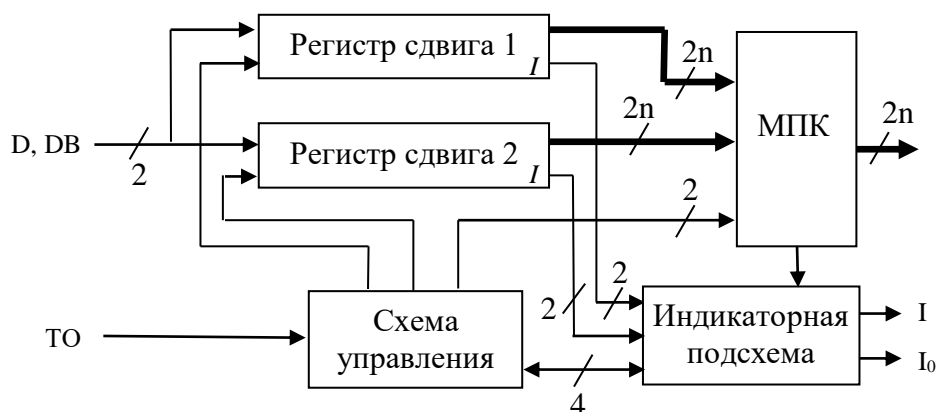
Рис. 4. Структурная схема самосинхронного отказоустойчивого регистра сдвига с дублированием
