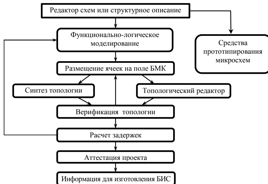
Рис. 1.1. Структурная схема САПР БИС «Ковчег 3.0»
