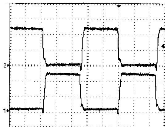
Рисунок 3 Осциллограмма напряжения на выводах A_i (2) и V_i (1)
