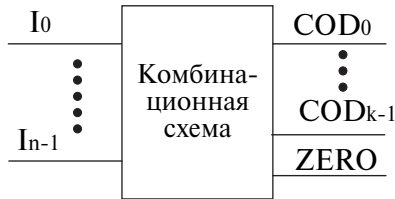
Функциональная схема стробируемого шифратора COD_{nkE}
