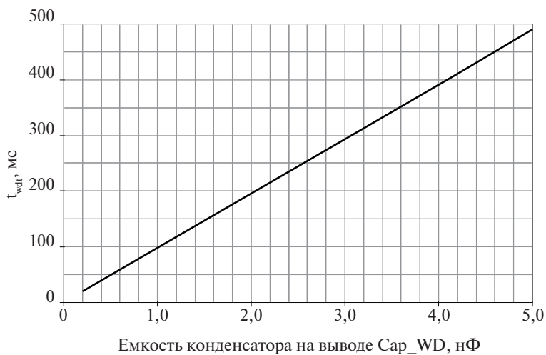
Рисунок 20.9. Зависимость времени t_{wdt} от емкости конденсатора на входе Cap_WD ( C_3 на рисунке 20.7)
